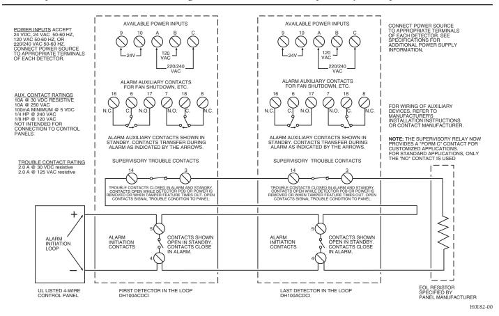
Figure 8. Wiring diagram for DH100ACDCI to APA451:
