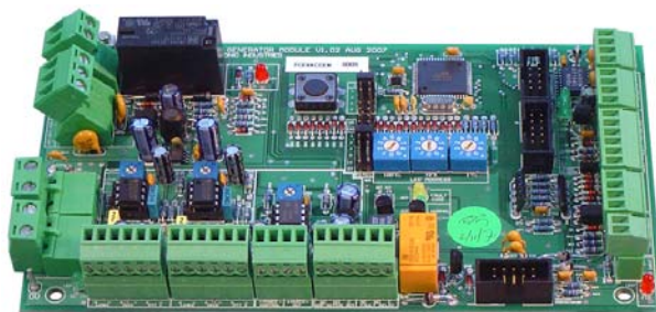
Evacuate Generator Module
